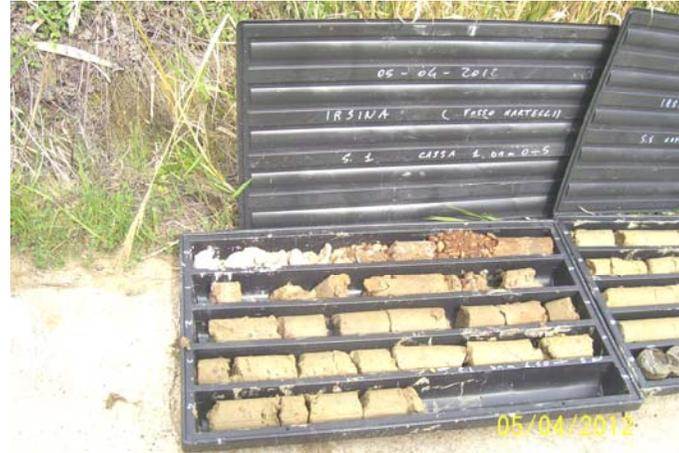
Foto n. 2 cassetta n 1 da 0.0 m a 5.00 m (sondaggio S.1)
