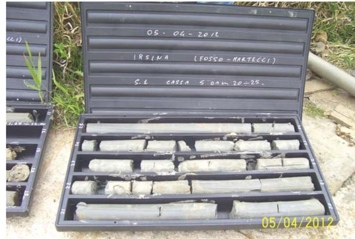
Foto n. 6 cassetta n 5 da 20m a 25 m ( sondaggio S1)
