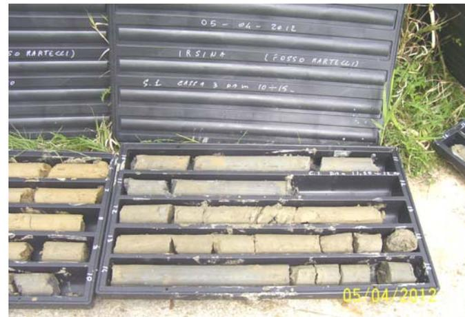
Foto n. 4 cassetta 3 da 10 m a 15 m (sondaggio S1)
