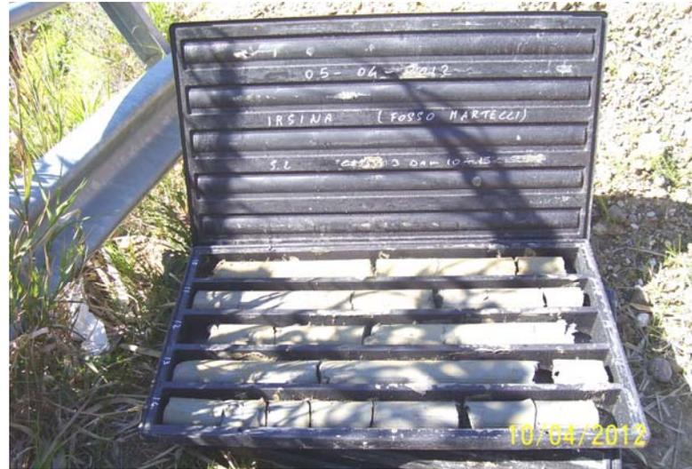
Foto n. 10 cassetta n. 3 da 10 a 15 m (sondaggio S2)
