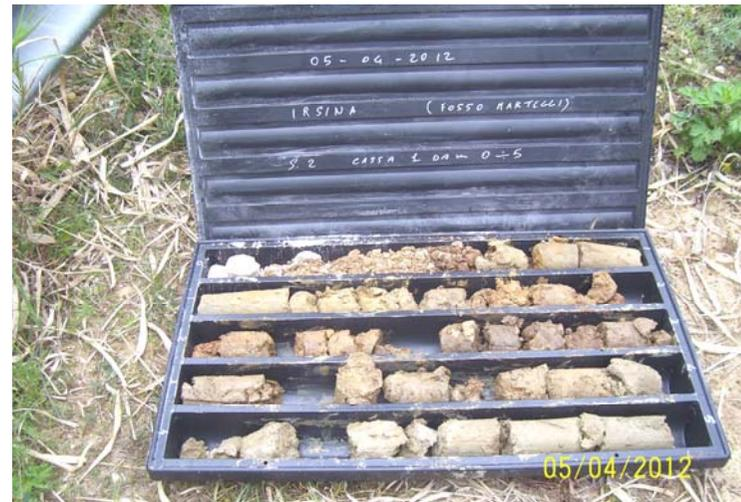
Foto n. 8 cassetta n. 1 da 0.0 m a 5.00 m (sondaggio S 2)
