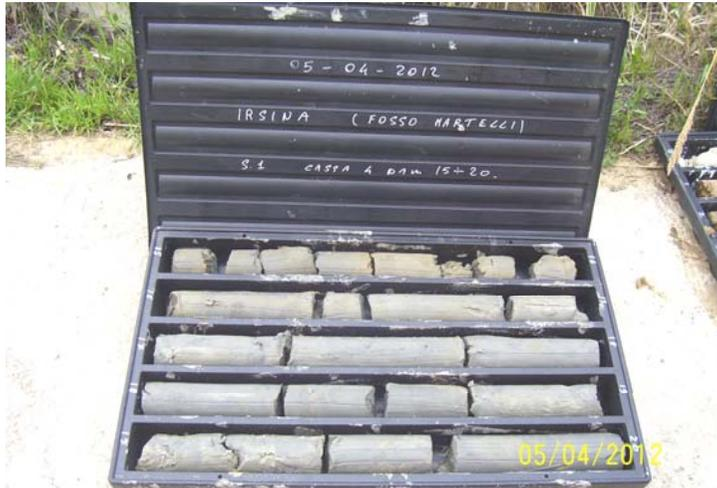
Foto .5 cassetta n. 4 da 15m a 20 m (sondaggio S 1)
