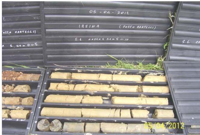
Foto n. 3 cassetta n. 2 da 5.00 a 10 m (sondaggio S 1)
