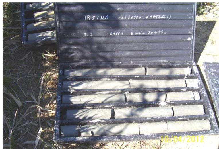
Foto n.12 cassetta n. 5 da 20 a 25 m (sondaggio S2)
