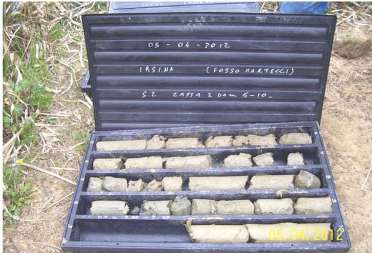
Foto n. 9 cassetta n. 2 da 5.00 a 10.0 m (sondaggio S2)
