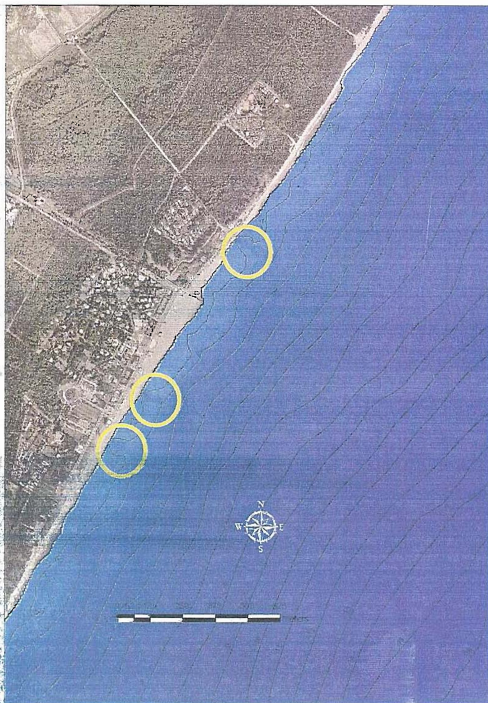
Figura 80 — Batimetria ex-post l'attività di ripascimento 2010 ("batimetria con canali") a alta risoluzione (5m x 5m)
