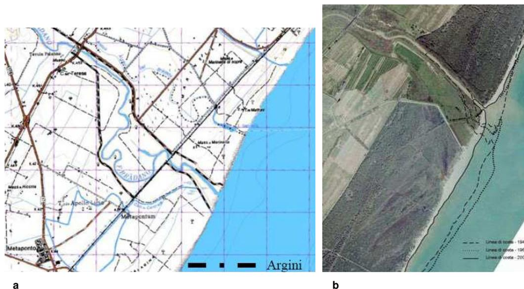
**Figura 7: Tratto terminale del Bradano, antico alveo in foce, su carta topografica al 50.000; b) ortofoto del 2006 che evidenzia l'evoluzione costiera in corrispondenza della foce del Fiume Bradano (dal 1949, linea tratteggiata, al 2006, linea continua).**
